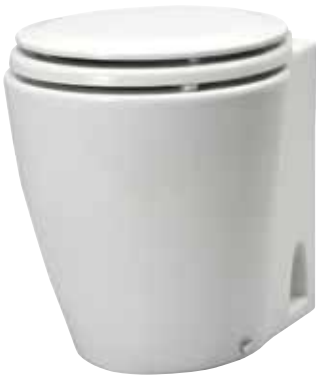
SR08530 Matromarine Laguna Elektrikli Tuvalet 12 V Ölçüler: En: 34 Boy: 41 Derinlik: 41 cm Su Girişi: 19 mm, Su Çıkışı: 38 mm
