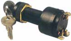
SR14101 Kontak Anahtarı - 12 A 3 Pozisyonlu 3 Terminal Off -On -Start Weatherproof ( Su Geçirmez Kılıflı )
