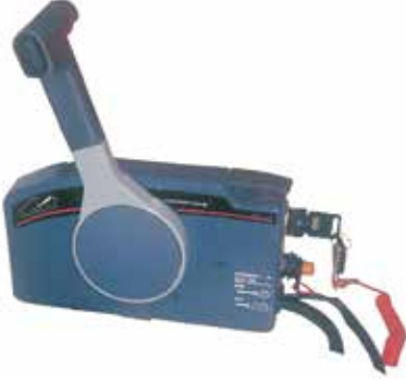
SR12052 Tekli Kol Yandan Montaj • Marşlı ve Trimli, 10 Pin'li • C 8 Tellerle Uyumludur
