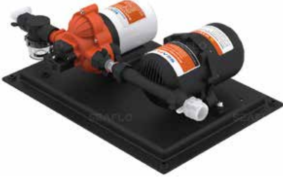
SR09680 Seaflo Tanklı Hidrofor 12 V - 11.3 lt. / dk Tank: 0,75 Lt , 45 Psi, 26x37 cm, Çıkış: 13 mm
