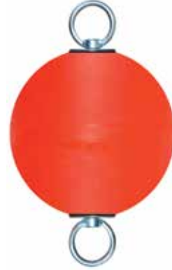
SR07886 Top Şamandıra 50 Litre Ağırlık: 4 kg Kaldırma: 30 kg Çap: 45 cm Boy: 65 cm SR07888 Top Şamandıra 320 Litre Ağırlık: 30 kg Kaldırma: 290 kg Çap: 85 cm Boy: 110 cm
