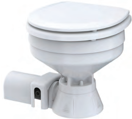
SR09736 Seaflo Elektrikli Tuvalet K.Taş 33x36x47 cm SR09740 Seaflo Elektrikli Tuvalet B.Taş 33x36x50 cm 12 V Su Girişi: 19 mm Su Çıkışı: 26 mm
