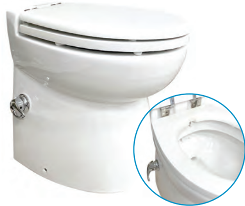
SR08526 Matromarine Vakumlu Tuvalet 12 V SR08528 Matromarine Vakumlu Tuvalet 24 V • Taharet Musluk Seti Tuvalete Dahildir. • En: 36 Boy: 46 Derinlik: 45 cm • Girişi: 26 mm, Çıkışı: 38 mm • Su Giriş İçin Harici Hidrofor Yada Selonoid Valf Kullanılmalıdır
