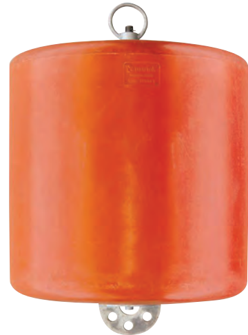
SR07879 Silindir Şamandıra 1200 Lt Ağırlık:90 kg Kaldırma:1200 kg Çap:110 cm Boy:115 cm
