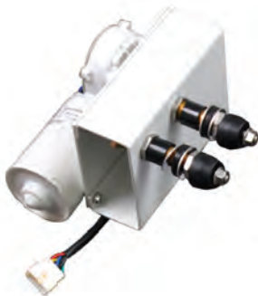
SR14433 Ağır Hizmet Silecek Motoru W.EM29230R-TM 24 V • Şaft: 102 mm • Silme Açısı: 90° • 120 W
