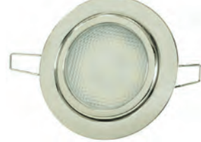
SR13280 Krom Gömme Spot 12 V, Gün Işığı, 9 Ledli SR13282 Krom Gömme Spot 24 V, Gün Işığı, 9 Ledli Çap: 65 mm, Montaj Çapı: 58 mm, Derinlik: 20 mm
