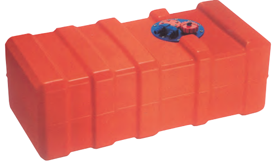
SR18294 Yakıt Tankı 70 lt 80x28x40 cm SR18295 Yakıt Tankı 84 lt 95x28x40 cm SR18296 Yakıt Tankı 102 lt 80x40x40 cm SR18297 Yakıt Tankı 120 lt 95x40x40 cm SR18298 Yakıt Tankı 140 lt 110x40x40 cm
