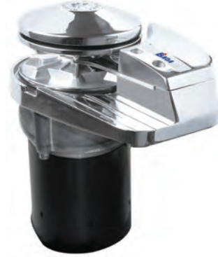
SR06704 Bada Dik Irgat 900 W - 12 Volt • Max Çek. Gücü 660 kg • Ağırlık: 8,5 kg • Zincir 6 mm Kalibre DIN 766 • 5-8 mt. Arası Tekneler İçindir. • Max 7 Kg Çıpayla Kullanılmalıdır • 80 Amper Sigorta ve 4 Tırnak Selonoid ile Kullanılır.
