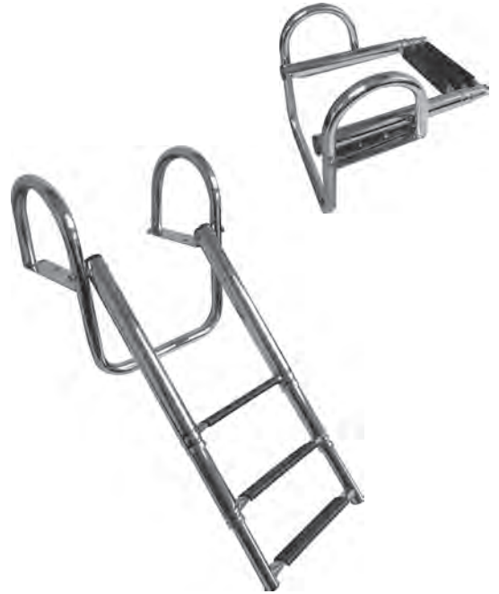
SR19152 Platform Üstü Teleskopik Krom Merdiven 3'lü Ölçüler: 30x92x16 cm Ø: 25 mm SR19154 Platform Üstü Teleskopik Krom Merdiven 4'lü Ölçüler: 30x102x16 cm Ø: 25 mm
